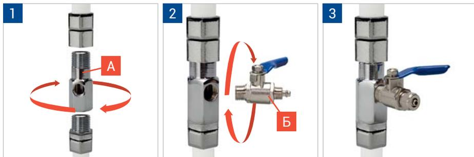
Вверните в адаптер шаровой кран (Б) подачи воды (рис. 2-3), уплотнив соединения.
